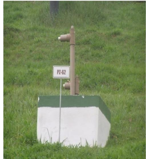
Figura 8: Exemplo de Piezômetro do tipo sifonado.
