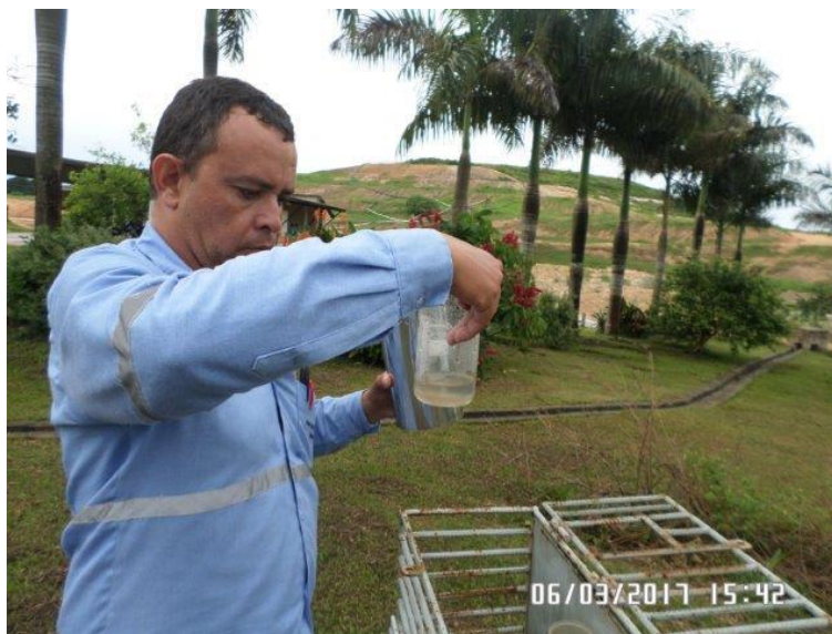
Figura 12: Leitura de pluviômetro em aterro sanitário.
